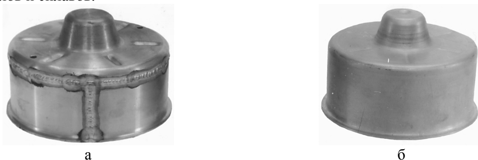
Рис. 2. Нижняя часть корпуса прибора 5: а – сварной вариант; б – отштампованная деталь.
